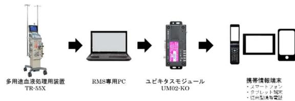
図2 遠隔監視システム模式図
